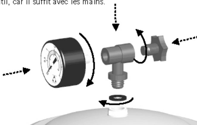
Montage du manomètre (avec vanne latérale)
