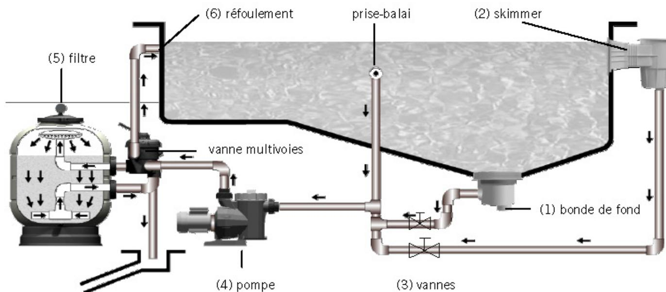
L'eau est aspirée du fond de la piscine par la bonde de fond (1) et à la surface par les skimmers (2) et arrivés au filtre (5) par des conduits séparés équipés chacun de vannes (3). L'eau filtrée est ensuite refoulée à la piscine par les bouches (6). Ces bouches de refoulement sont installées du côté opposé des skimmers et de la bonde de fond renouvelant ainsi toute l'eau de la piscine.
